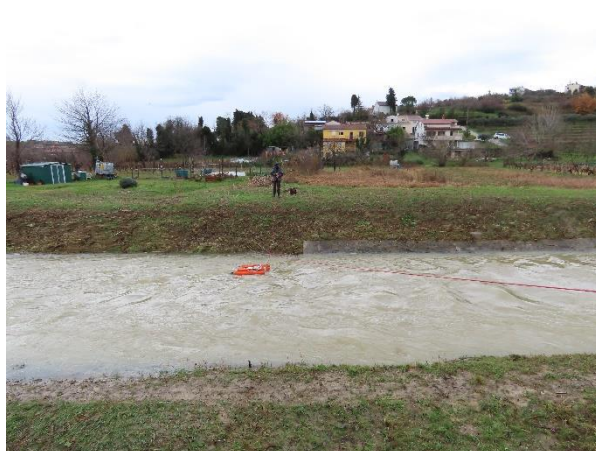
Slika 19: Meritev pretoka Badaševice v Šalari 7. decembra 2020 (levo) in 9. decembra 2020 (desno) (foto: Primož Gajser)
