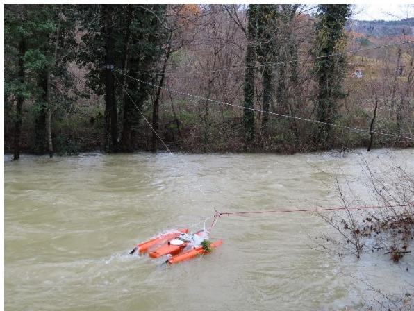
Slika 17: Meritev pretoka Rižane v Kubedu 7. decembra 2020 (levo) in 9. decembra 2020 (desno) (foto: Primož Gajser)
