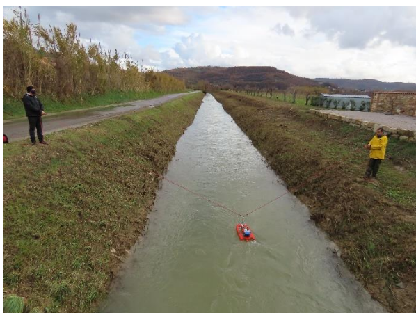
Slika 20: Meritev pretoka Drnice v Pišinah 7. decembra 2020 (levo) in 9. decembra 2020 (desno) (foto: Primož Gajser)
