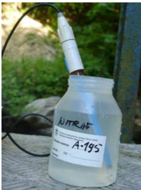
Slika 8: Meritev električne prevodnosti v vzorcu vode
