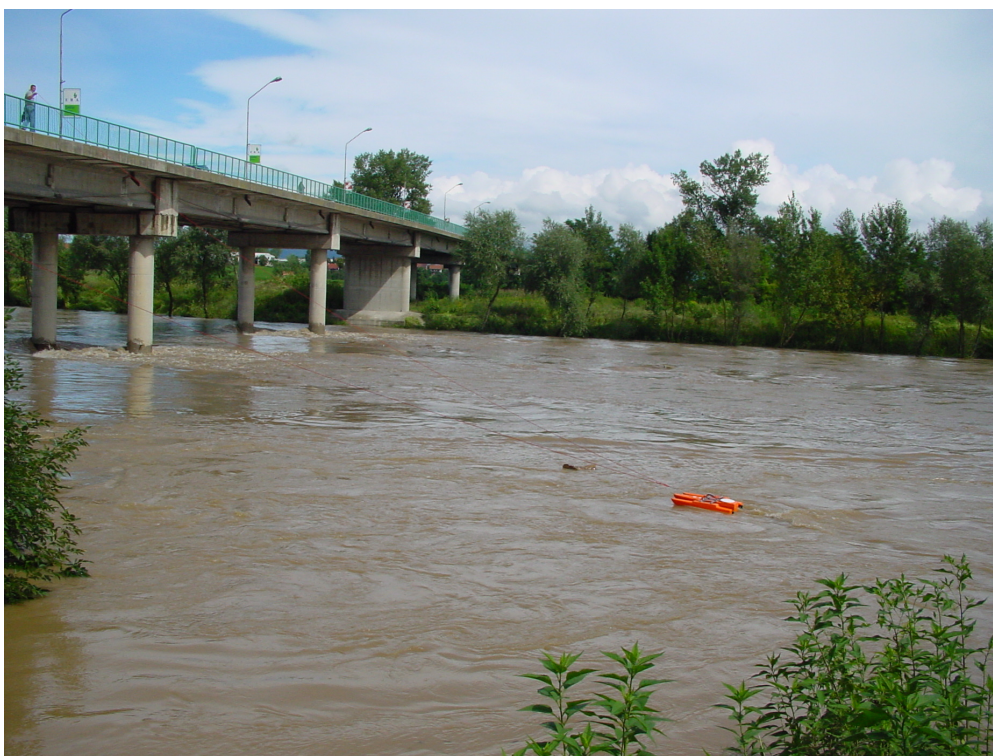
Slika 16: Izvajanje meritve pretoka z akustičnim Dopplerjevim merilnikom ADCP v Čatežu na Savi 22. avgusta 2005 (foto: Marko Burger)
